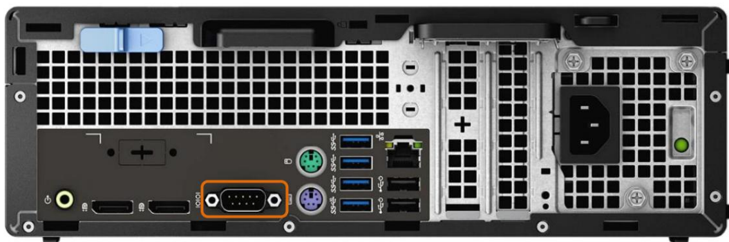
Figure 7-5 | Exemple de PC avec port RS-232 (interface)
